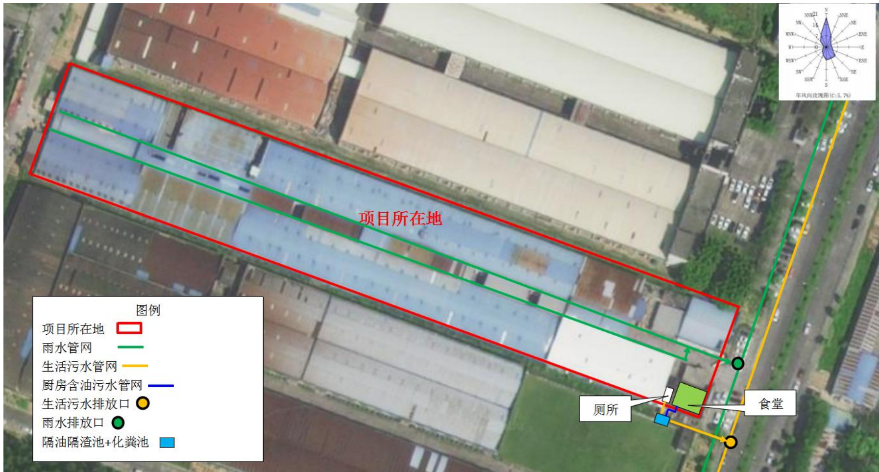
附图 11 项目厂区雨污管网图
